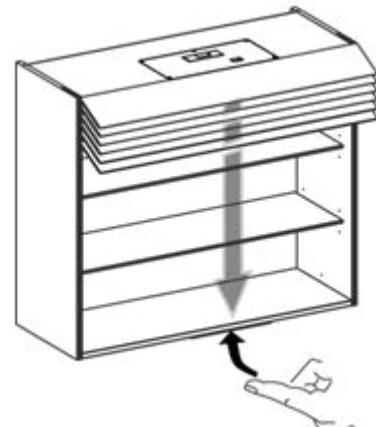
现在通过短时间触摸传感器可以完全关闭帘子。
